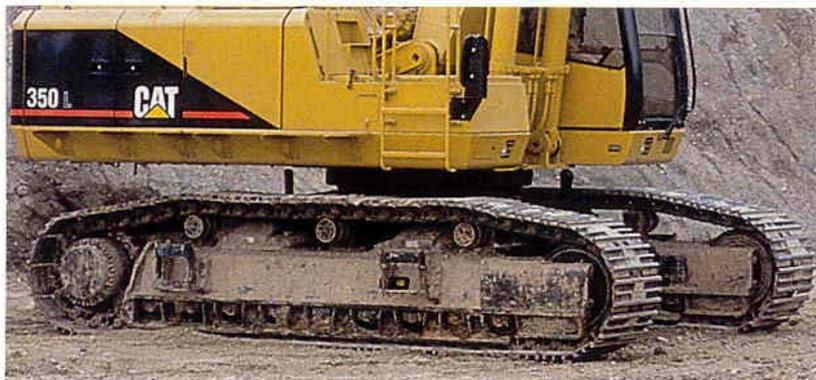
**Standard-Laufwerk.** Diese Ausführung ist erste Wahl, wenn es um beste Manövrierfähigkeit und kleine Wendekreise geht. Bei schweren Einsätzen in Hartgestein und unebenem Gelände bietet das Standard-Laufwerk erfahrungsgemäß optimale Dauerfestigkeit.
